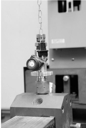
スを止めるタイプであり、過流式はガス放出防止器の下流で多量のガス放出があったとき作動するものである。
