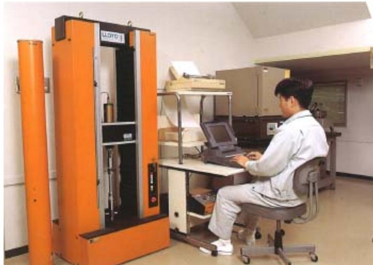
配管用フレキ管引張試験
